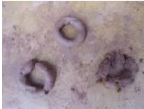
Figura 3: exemplo de três tipos de solo: argiloso, intermediário e arenoso
